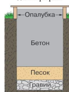
Рис. 2. Структура фундамента дома в разрезе
